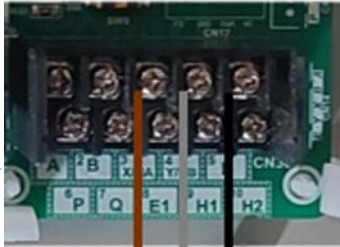
X/HA Y/HB E Til varmepumpe Stel 3x0,75 mm 2 MH-kit skærmet
